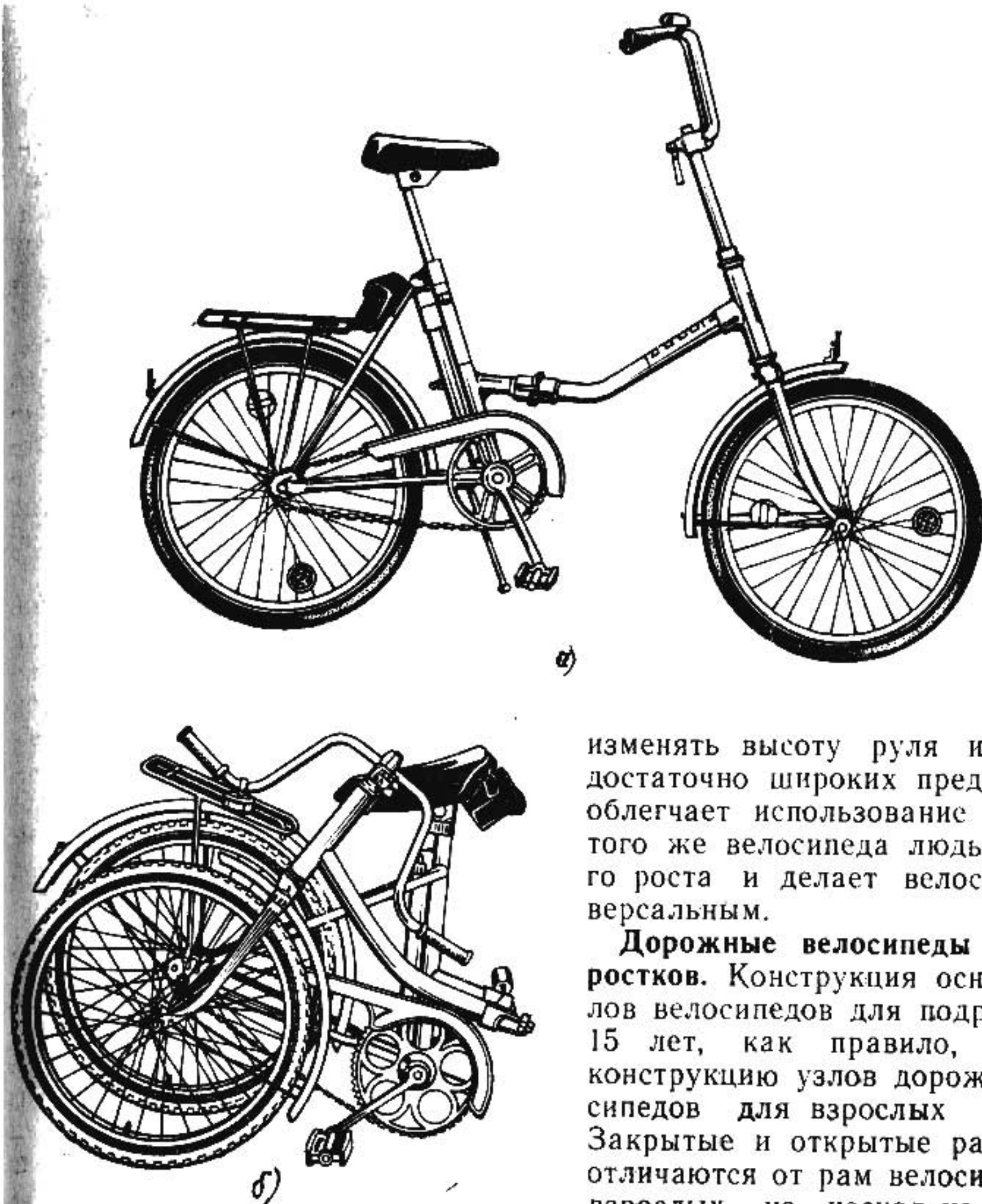
Рис. 14. Складной дорожный велосипед: а — велосипед в рабочем состоянии; б — велосипед в сложенном виде
